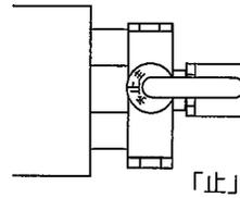
②炎が消えたらバーナ用コックを「予」にして、予熱用ノズルから灯油を2～3秒間出し、予熱用ノズルを洗浄してください。（点火はしない。）
