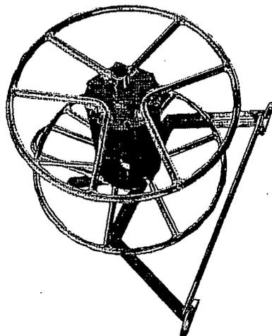
③平坦な地面の上を立て、ドラムのパイプをフレームの軸受部に挿入します。
