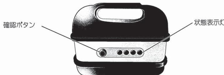
本機に装着時は電源スイッチをOFFにし、本機側面のシャッタを開けて、確認してください。確認後は、必ずシャッタを閉じてください。
