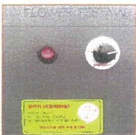
14. ①噴射量調節スイッチを3段に設定して②スイッチを(on)作動する ③噴射量を1' 2' 3段を選択'調節する'
