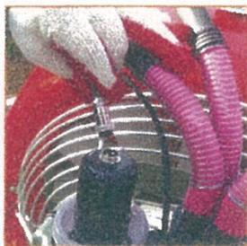
10. 攪拌器の電源コネクタジャックを左側に回し'分離する
