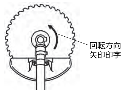
【刈刃の正しい取り付け方向】
